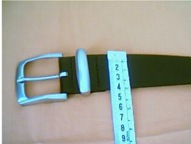
Resim 1.8: Kemer en ölçüsünün alınması
