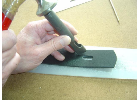
Resim 1.37: Deride dil yuvasının delinmesi
