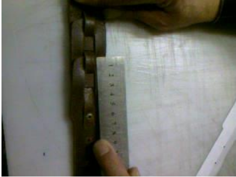
Resim 3.21: Örgülü kısmın ölçülmesi
