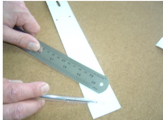
Resim 2.14: Aks. montaj delik yerinin tespiti
