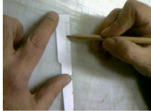
Resim 3.22: Oyulacak kısmın çizimi
