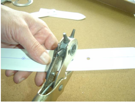
Resim 1.26: Çarklı zımba ile delme
